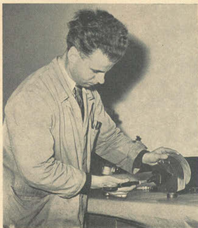
Hier wird gerade eine Zylinderlaufbahn geprüft. Das Meßgerät mißt auf ein Tausendstel genau
