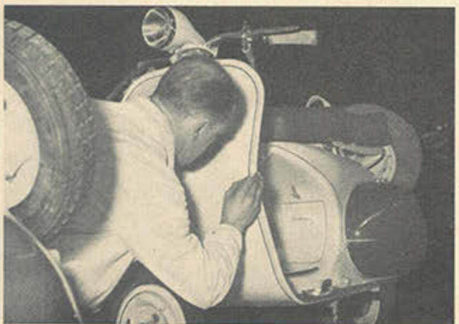
Das Ziehen der Zierlinien erfordert eine besonders geschickte Hand. Hier hat das Argus-Auge des Meisters noch einen winzigen Kratzer entdeckt. Die Maschine verläßt das Werk nicht eher, bis er nicht ausgebessert ist.
