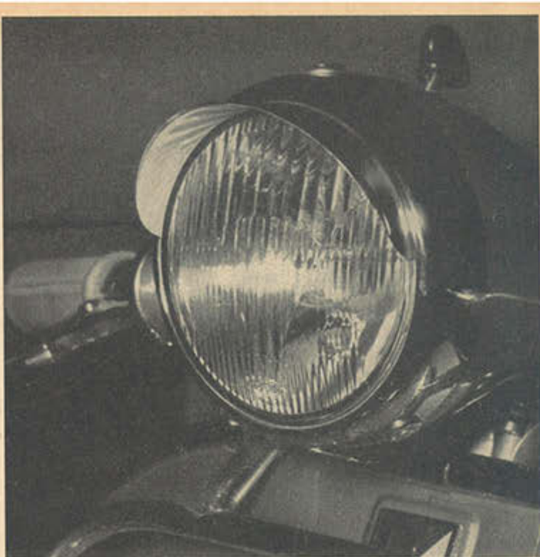
Durch seine starre Befestigung am Lenker sind beim Vespa-Scheinwerfer große Einstellfehler unmöglich. Die kleine Blendklappe erweist sich besonders bei Regen und Nebelfahrten besonders wertvoll.
