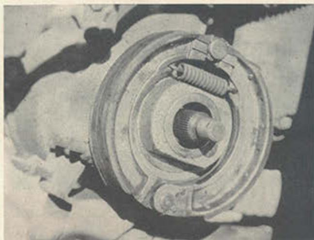
So sitzen die Bremsbacken mit den aufgenieteten Bremsbelägen auf der Bremsonkerplatte.
