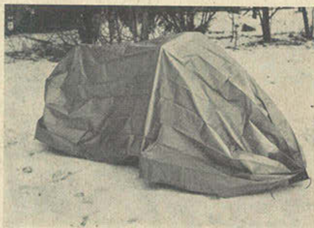
Diese Vespa ist mit einer Folienhaut bedeckt. Um diese „Omnia-Garage“ zu falten, hat man nicht mehr zu tun, als an den Griffen vorn und hinten fest zu ziehen — schon ist sie säuberlich in eine schmale Bahn zusammengelegt.
