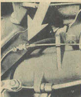
Abb. 4 Kupplungsdruckhebel mit Nachstellschraube
