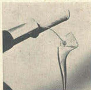
Abb. 2: Handbremshebel sämtlicher Typen
